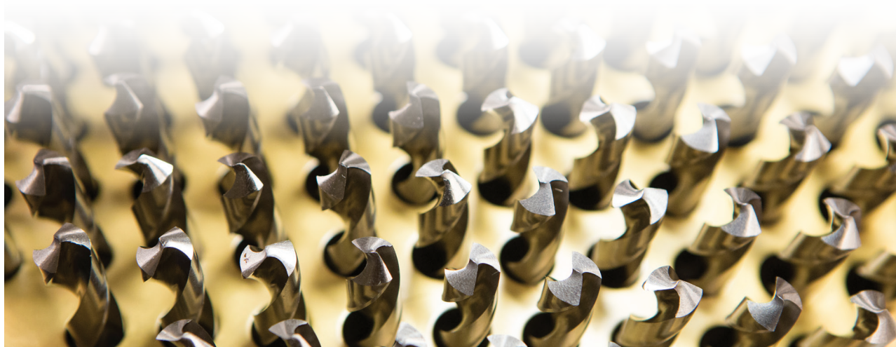
Roterande snabbstål- och hårdmetallverktyg slipar vi om, ombelägger och preparerar.
